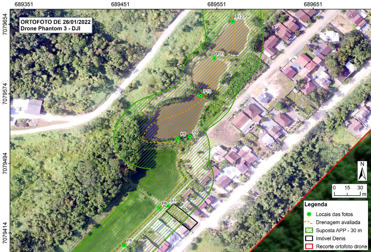
Figura 18. Enfoque na área do imóvel a partir da ortofoto proveniente do levantamento com drone. A título de exemplo, caso a drenagem (canal de irrigação) existente nos fundos do imóvel fosse um curso d'água (rio), inseriu-se a delimitação de sua suposta APP de 30 metros com a ferramenta buffer do ArcGIS 10.3. Observa-se que, caso existisse a APP exposta, diversas edificações recém-construídas estariam dentro da área restrita por lei. Deste modo, caberia o questionamento de como as mesmas foram autorizadas pelos órgãos competentes municipais há pouco.
